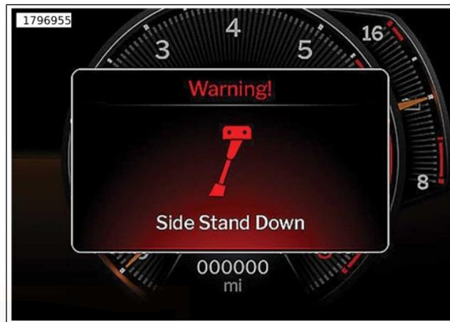
**Abbildung 42. Meldung „Ausgeklappter Seitenständer“**
