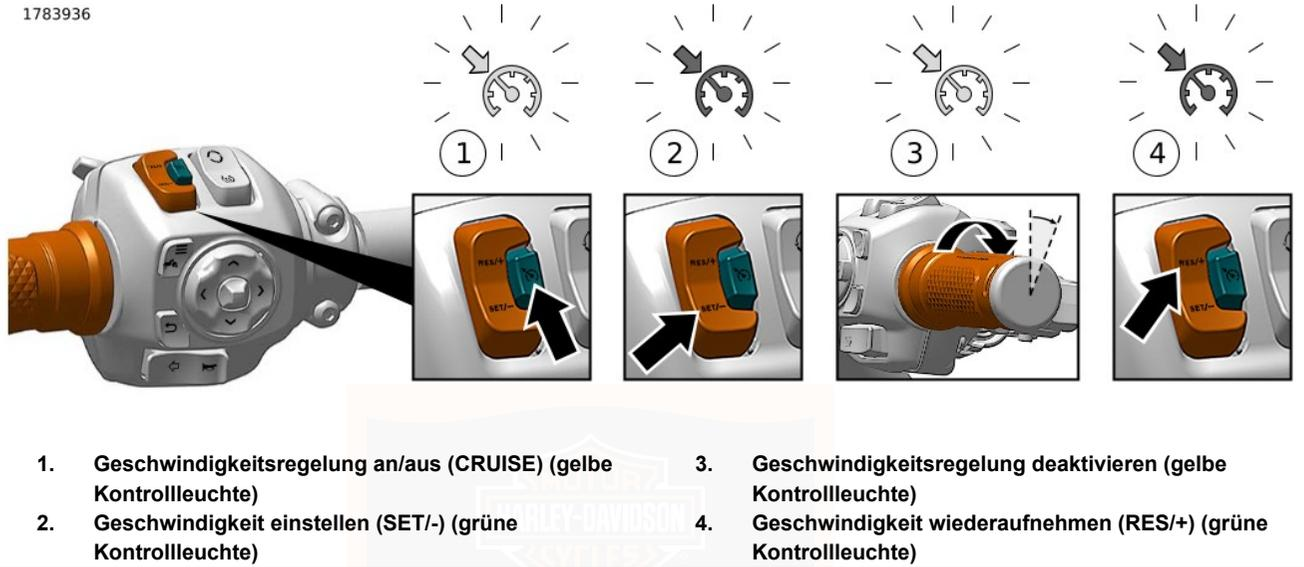
Abbildung 51. Geschwindigkeitsregelung (typisch)
