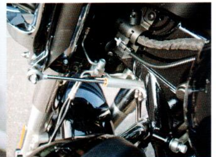
Macht seine Arbeit gut - der Lenkungsdämpfer.
