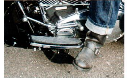
↑ Harley-Trittbretter: bequemer gehts nicht. ↓ Die Feststellbremse wird mit dem Absatz aktiviert.
