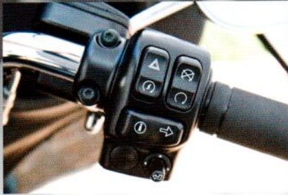
↑ Die Lenkerarmaturen tragen neue Schalter – inklusive Mini-Joysticks zur Navigation durch das Bordmenü.
