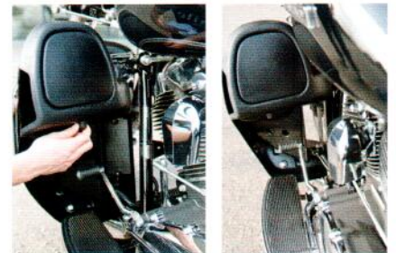
Klappe auf - Fahrtwind rein: die Splitstream-Belüftung.
