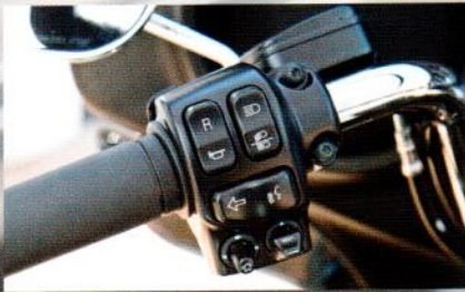
↑ Die Lenkerarmaturen tragen neue Schalter – inklusive Mini-Joysticks zur Navigation durch das Bordmenü.
